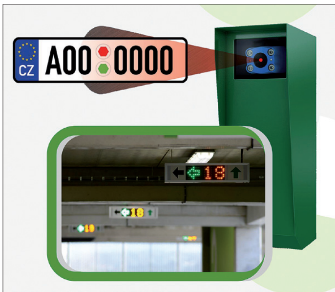
Obr. 5 Při parkování zajistí inteligentní systém automatické vpuštění na základě rozpoznání registrační značky
