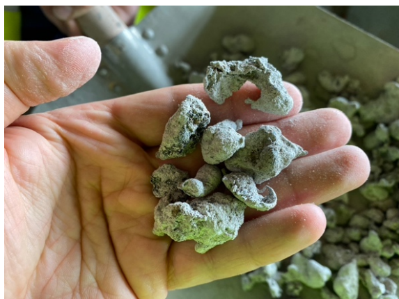
OBRÁZEK 1: HLINÍKOVÉ PLECHOVKY PO PRŮCHODU KOTLEM ZEVO JSOU SPEČENÉ A ZBAVENÉ VŠECH NEČISTOT, ZDROJ: FOTOARCHIV INCIEN Z EXKURZE DO ZEVO SAKO BRNO
