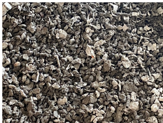
OBRÁZEK 2: HLINÍKOVÉ PLECHOVKY PO PRŮCHODU KOTLEM ZEVO JSOU SPEČENÉ A ZBAVENÉ VŠECH NEČISTOT, ZDROJ: FOTOARCHIV INCIEN Z EXKURZE DO ZEVO SAKO BRNO
